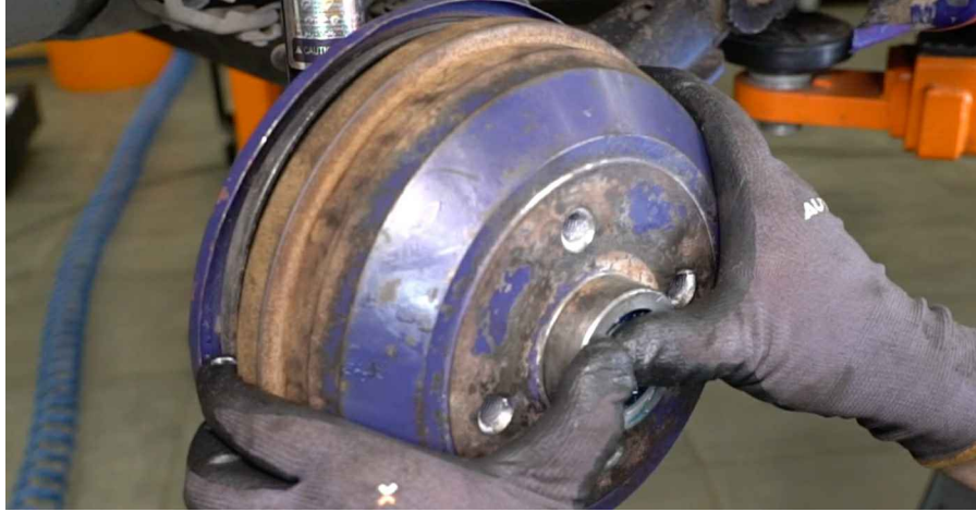
45 Bringen Sie die Unterlegscheibe des Radlagers an.
