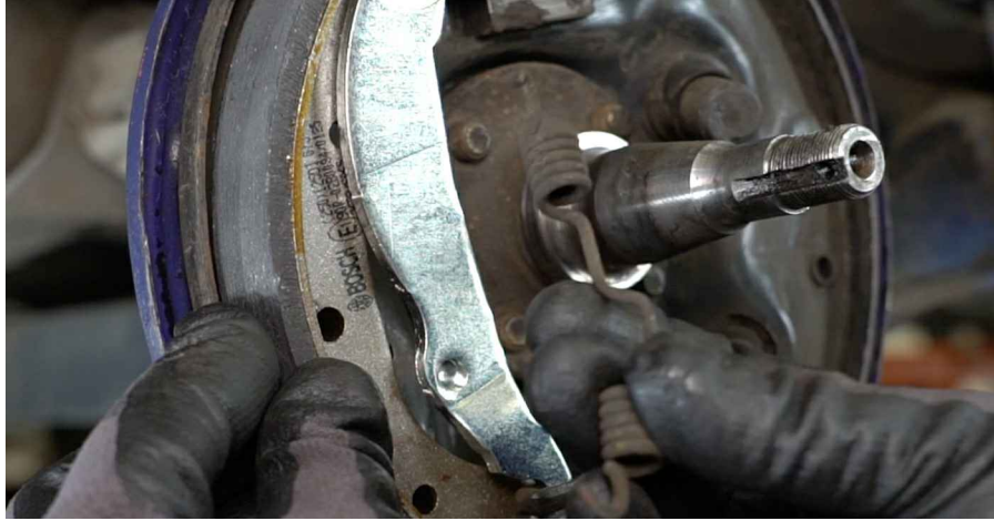
25 Bauen Sie die untere Rückstellfeder ein.
