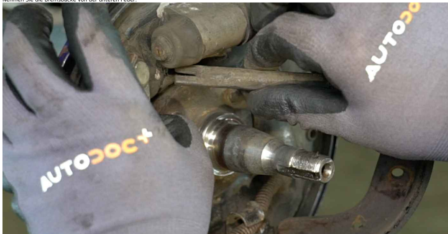
18 Entfernen Sie die rechte Bremsbacke.
