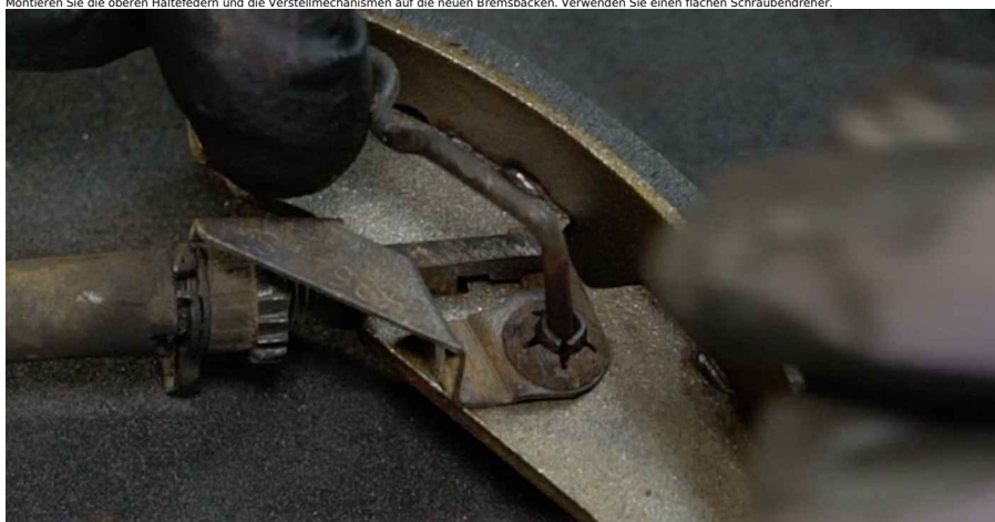
35 Montieren Sie die oberen Haltefedern und die Verstellmechanismen auf die neuen Bremsbacken. Verwenden Sie einen flachen Schraubendreher.
