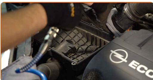
**Austausch: Luftfilter – OPEL Corsa C Limousine (X01). Tipp von AUTODOC-Experten:**
