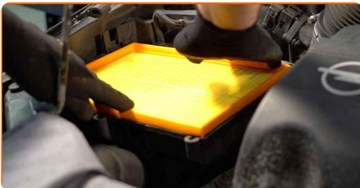
**Austausch: Luftfilter – OPEL Corsa C Limousine (X01). AUTODOC-Experten empfehlen:**
