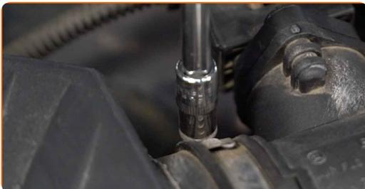
**4** Trennen Sie das Luftansaugrohr vom Luftfilter-Gehäuse.
