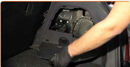
5 Entfernen Sie die Abdeckung des Rücklichts.
