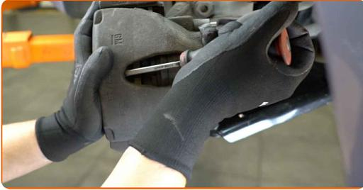
**11** Entfernen Sie den Bremssattel.
