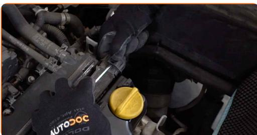
**4** Schrauben Sie die Zündspulenklammer ab. Verwenden Sie den Torx T30. Verwenden Sie einen Ratschenschlüssel.
