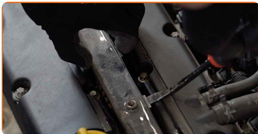
**6** Entnehmen Sie die Zündspule aus der Vertiefung für die Zündkerze.
