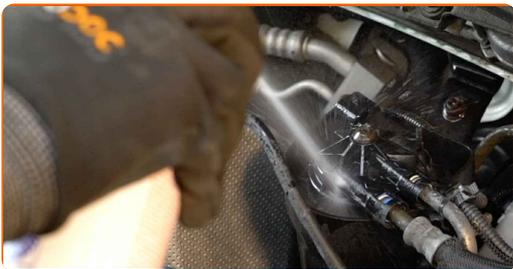
**10** Schrauben Sie die Befestigungen vom Deckel des Kraftstofffiltergehäuses ab. Verwenden Sie den Torx T30. Verwenden Sie einen Ratschenschlüssel.
