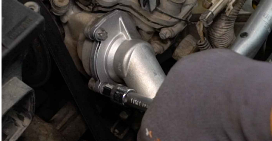
28 Bringen Sie den Kühlmittelschlauch an.
