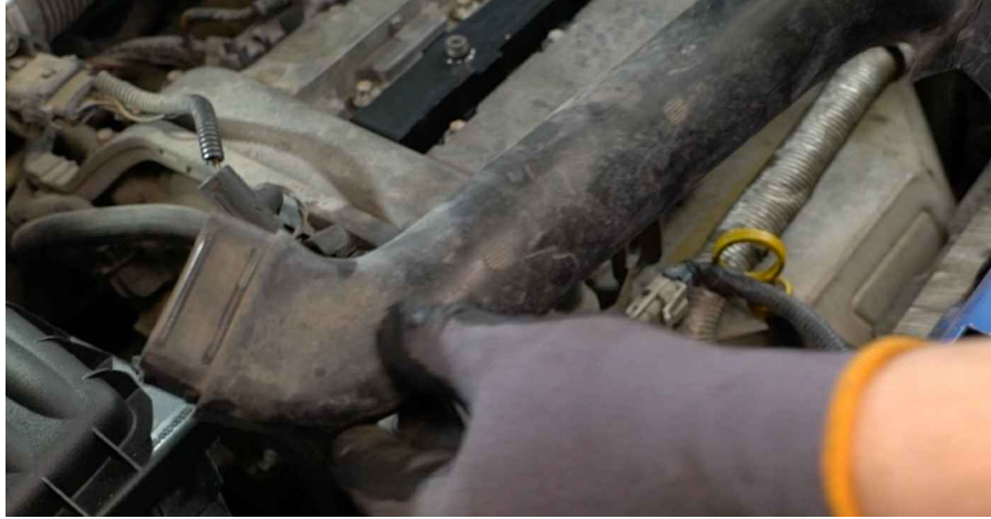
15 Reinigen Sie die Verbindungen des Kühlmittelschlauchs. Verwenden Sie Allzweckreinigungsspray.
