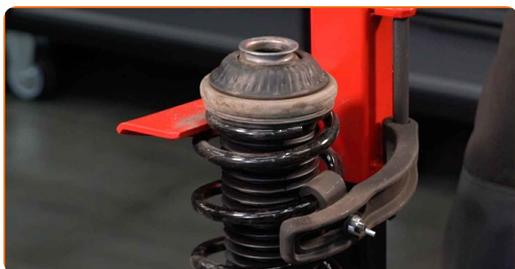
**38** Entfernen Sie das zusammengebaute Federbein.
