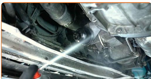
**11** Schrauben Sie den Filterdeckel zusammen mit dem alten Filtereinsatz ab. Verwenden Sie eine Stecknuss mit einem Durchmesser von 27 mm. Verwenden Sie einen Ratschenschlüssel.
