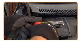
Entfernen Sie die Dichtung der Windabweiserabdeckung.
