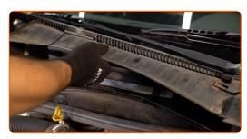
Reinigen Sie den Montagesitz des Innenraumfilters.
