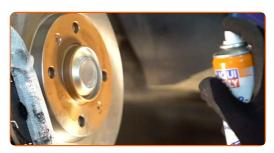
Die Bremsscheibenoberfläche reinigen. Benutzen Sie einen Bremsenreiniger.
