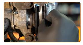
Bringen Sie die Halterklammer der Bremsbeläge an. Benutzen Sie ein Brecheisen.
