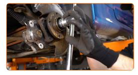
Entfernen Sie die Nabe und das Lager zusammen, da sie eine versiegelte Einheit sind. Benutzen Sie einen dreiarmigen Abzieher.
