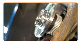
Ziehen Sie die Nabe hindurch. Verwenden Sie Stecknuss Nr. 32. Verwenden Sie einen Drehmomentschlüssel. Ziehen Sie ihn mit 230 Nm Drehmoment fest.
