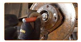
Schrauben Sie die Radnaben-Achsmutter ab. Verwenden Sie Stecknuss Nr. 32. Verwenden Sie ein Windeisen.
