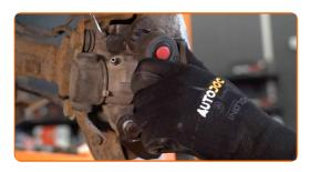
Entfernen Sie den Bremssattel.
