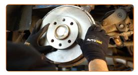
Ziehen Sie die Befestigung der Bremsscheibe fest. Verwenden Sie den Torx T30. Verwenden Sie einen Drehmomentschlüssel. Ziehen Sie ihn mit 9 Nm Drehmoment fest.
