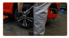
Entfernen Sie den Wagenheber sowie die Unterlegkeile.
