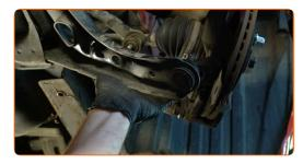
Schrauben Sie das Befestigungselement heraus, das die Druckstange mit dem Stabilisator verbindet. Verwenden Sie Ring-Gabelschlüssel Nr. 10. Verwenden Sie Stecknuss Nr. 12. Verwenden Sie einen Ratschenschlüssel.
