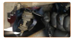
Entfernen Sie die Stabilisatorstange. Benutzen Sie ein Brecheisen.
