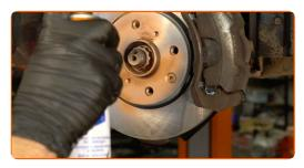
Reinigen Sie die Oberfläche an welcher die Felge montiert werden soll. Benutzen Sie einen Bremsenreiniger.
