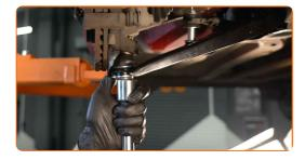
Ziehen Sie das Kugelgelenk an. Verwenden Sie Ring-Gabelschlüssel Nr. 19. Verwenden Sie einen Drehmomentschlüssel. Ziehen Sie ihn mit 98 Nm Drehmoment fest.
