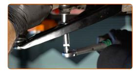
Entfernen Sie den Träger unter dem Arm.
