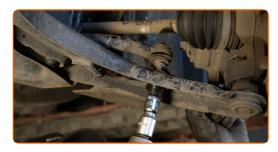
Entfernen Sie den Splint. Benutzen Sie ein Brecheisen.
