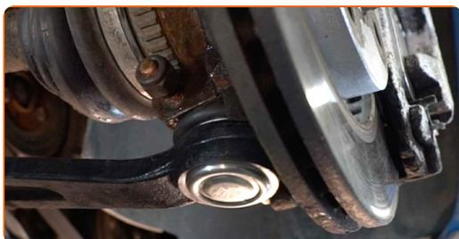
**33** Schrauben Sie die Befestigungen des Kugelgelenks ein. Verwenden Sie Stecknuss Nr. 17. Verwenden Sie Ring-Gabelschlüssel Nr. 17.
