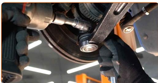
**34** Ziehen Sie das vordere Befestigungselement an, das den Querlenker mit dem Hilfsrahmen verbindet. Verwenden Sie Stecknuss Nr. 21. Verwenden Sie einen Drehmomentschlüssel. Ziehen Sie ihn mit 111 Nm Drehmoment fest.
