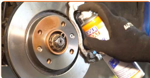
**41** Die Bremsscheibenoberfläche reinigen. Benutzen Sie einen Bremsenreiniger.
