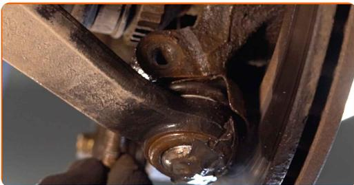
**15** Lösen Sie die Befestigung, die das Kugelgelenk des Querlenkers mit dem Achsschenkel verbindet. Verwenden Sie einen flachen Metallmeißel. Benutzen Sie einen Hammer.
