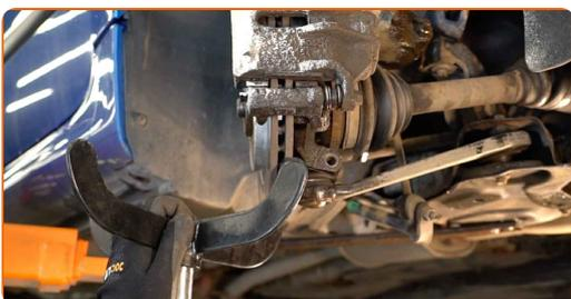
**17** Ziehen Sie den unteren Arm vom Achsschenkel ab. Benutzen Sie ein Brecheisen.
