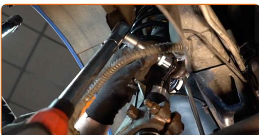
**12** Ziehen Sie das Befestigungselement an, das die Druckstange mit dem Stabilisator verbindet. Verwenden Sie Ring-Gabelschlüssel Nr. 17. Verwenden Sie den Torx T30. Verwenden Sie einen Drehmomentschlüssel. Ziehen Sie ihn mit 35 Nm Drehmoment fest.
