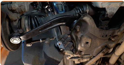
**11** Ziehen Sie das Befestigungselement an, das die Druckstange mit dem Federbein verbindet. Verwenden Sie Ring-Gabelschlüssel Nr. 17. Verwenden Sie den Torx T30. Verwenden Sie einen Drehmomentschlüssel. Ziehen Sie ihn mit 35 Nm Drehmoment fest.
