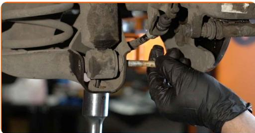
**11** Den Stoßdämpfer entfernen.
