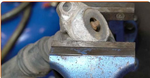
**13** Reinigen Sie die Befestigungen vom Stoßdämpferschaft. Benutzen Sie eine Drahtbürste. Benutzen Sie WD-40-Spray.
