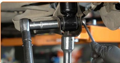
**27** Die Montage unter dem Hinterachsträger entfernen.
