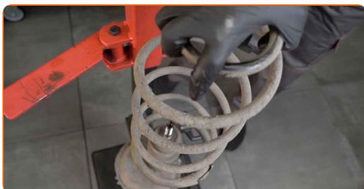
**39** Die Staubkappe des Stoßdämpfers und den Anschlagpuffer entfernen.
