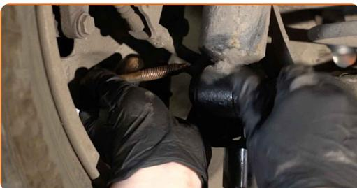
**15** Die Montage unter dem Hinterachsträger entfernen.
