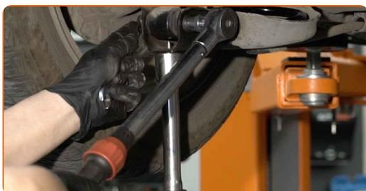
**22** Die Montage unter dem Hinterachsträger entfernen.
