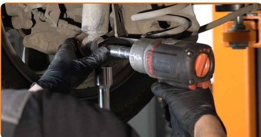
**14** Entfernen Sie die Befestigungsschraube.
