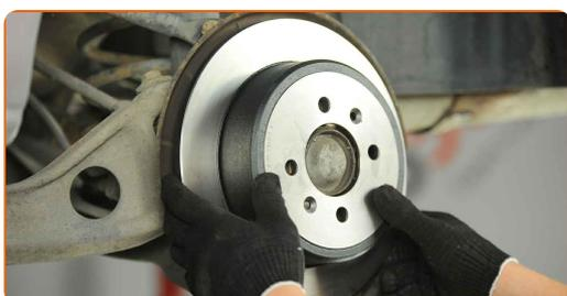
**20** Ziehen Sie die Bremsscheibenbefestigungen an. Verwenden Sie den Torx T30. Verwenden Sie einen Drehmomentschlüssel. Ziehen Sie ihn mit 10 Nm Drehmoment fest.
