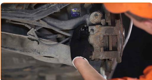
**12** Schrauben Sie die Befestigungen des Bremssattels ab. Verwenden Sie Inbusschlüssel Nr. H7. Verwenden Sie Stecknuss Nr. 16. Verwenden Sie einen Ratschenschlüssel.
