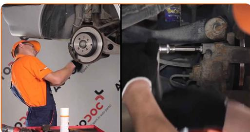
**27** Installieren Sie die Staubschutzkappen der Bremssattel-Führungsstifte.
