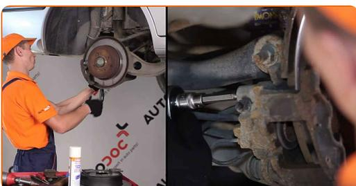
**13** Entfernen Sie die Befestigungsschrauben.
