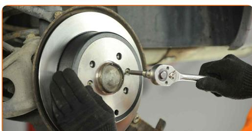
**21** Die Bremssattelbefestigungen reinigen. Benutzen Sie eine Drahtbürste. Benutzen Sie WD-40-Spray.
