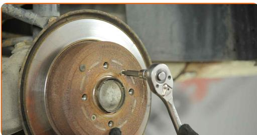
**17** Entfernen Sie die Bremsscheibe.
