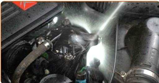
**4** Schrauben Sie die Befestigungen des Kraftstofffilterdeckels ab. Verwenden Sie Inbusschlüssel Nr. H4. Verwenden Sie einen Ratschenschlüssel.
