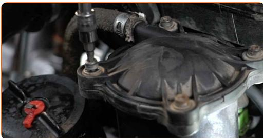
**5** Entfernen Sie den Deckel des Kraftstofffiltergehäuses.
