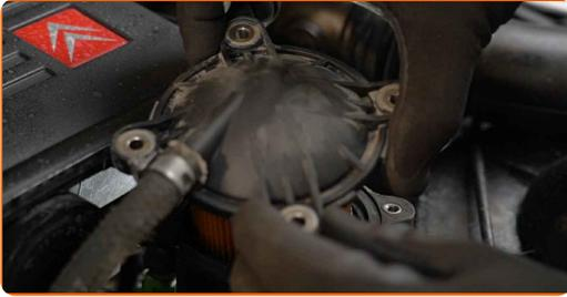
**6** Entfernen Sie den Kraftstofffilter.
