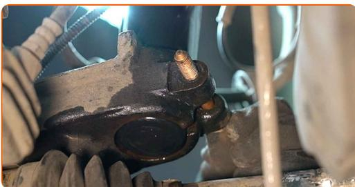
**60** Schrauben Sie die unteren Befestigungen des Federbeins fest. Verwenden Sie Stecknuss Nr. 16. Verwenden Sie einen Drehmomentschlüssel. Ziehen Sie ihn mit 55 Nm Drehmoment fest.
