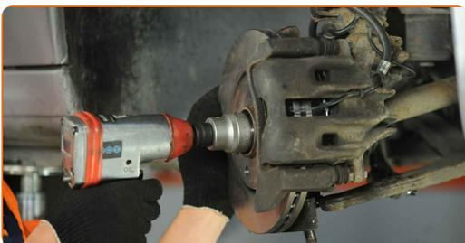
**20** Entfernen Sie die Befestigungsmutter.
