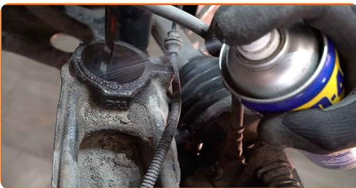
**57** Lösen Sie das untere Befestigungselement, dass das Federbein mit dem Achsschenkel verbindet. Verwenden Sie einen flachen Metallmeißel. Benutzen Sie einen Hammer.
