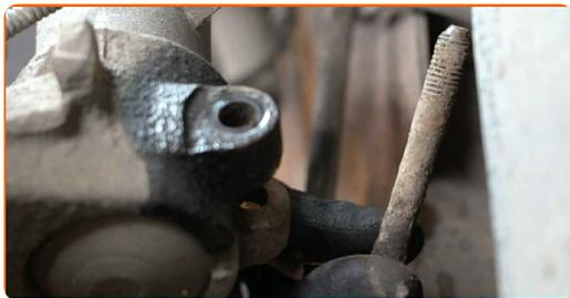
**25** Lösen Sie das untere Befestigungselement, dass das Federbein mit dem Achsschenkel verbindet. Verwenden Sie einen flachen Metallmeißel. Benutzen Sie einen Hammer.
