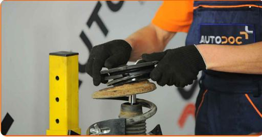
**47** Ziehen Sie die Federbeinkolbenstangenmutter an. Verwenden Sie Ring-Gabelschlüssel Nr. 21. Verwenden Sie Inbusschlüssel Nr. H6. Verwenden Sie einen Drehmomentschlüssel. Ziehen Sie ihn mit 65 Nm Drehmoment fest.
