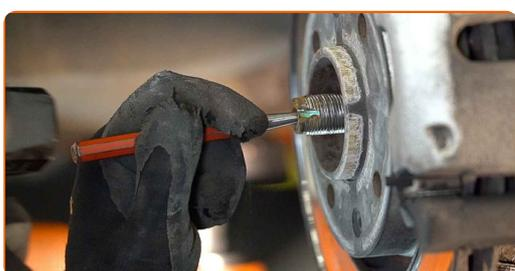
**22** Reinigen Sie die untere Befestigung, die das Federbein mit dem Achsschenkel verbindet. Benutzen Sie eine Drahtbürste. Benutzen Sie WD-40-Spray.
