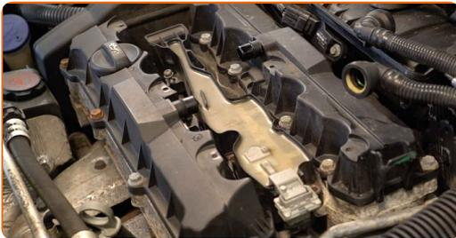
**19** Ziehen Sie die Befestigungen der Zündspulen fest. Verwenden Sie den Torx T20. Verwenden Sie einen Drehmomentschlüssel. Ziehen Sie ihn mit 8 Nm Drehmoment fest.
