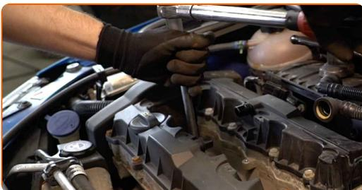
**Austausch: Zündkerzen – PEUGEOT EXPERT Kasten (VF3A\_, VF3U\_, VF3X\_).
