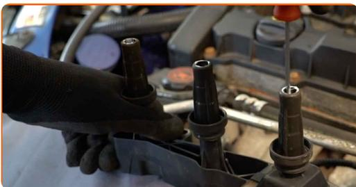
**17** Schließen Sie den Anschluss der Zündspule an.
