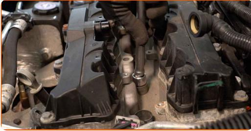
**15** Schrauben Sie die neuen Zündkerzen an und ziehen Sie diese fest. Verwenden Sie die Zündkerzennuss # 16. Verwenden Sie einen Drehmomentschlüssel. Ziehen Sie ihn mit 26 Nm Drehmoment fest.
