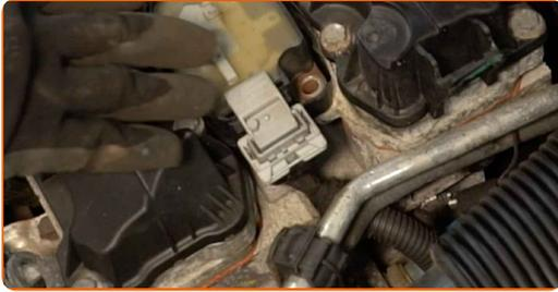
**18** Bringen Sie die Zündspulen an den Zündkerzenbohrungen an. Stellen Sie sicher, dass Sie dabei das Klicken hören, welches entsteht, wenn sich diese in der korrekten Position befindet.
