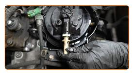
Bringen Sie den Anschluss des Kraftstoffdrucksensors an.
