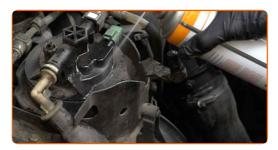
Trennen Sie den Anschluss des Kraftstoffdrucksensors. Verwenden Sie einen flachen Schraubendreher.
