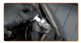
Schrauben Sie die Befestigungen vom Deckel des Kraftstofffiltergehäuses ab. Verwenden Sie Stecknuss Nr. 27. Verwenden Sie einen Ratschenschlüssel.
