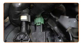
Reinigen Sie die Kraftstoffleitungen. Verwenden Sie Allzweckreinigungsspray.
