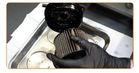
Reinigen Sie die Abdeckung und das Gehäuse des Kraftstofffilters. Verwenden Sie Allzweckreinigungsspray.
