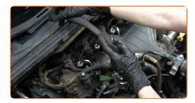
Entfernen Sie die mit einer alten Filterkartusche zusammengebauten Kraftstofffilterabdeckung.
