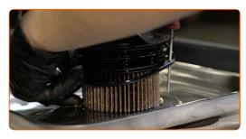
Entfernen Sie den Kraftstofffilter.
