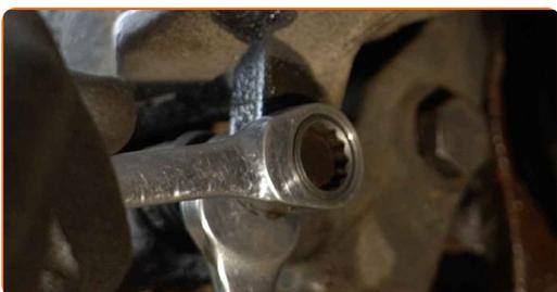
**10** Entfernen Sie die Befestigungsschrauben.
