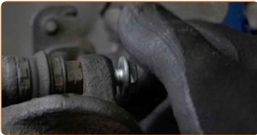
**20** Ziehen Sie die Bremssattelbefestigungen fest. Verwenden Sie Ring-Gabelschlüssel Nr. 13. Verwenden Sie Ring-Gabelschlüssel Nr. 15. Verwenden Sie einen Drehmomentschlüssel. Ziehen Sie ihn mit 27 Nm Drehmoment fest.
