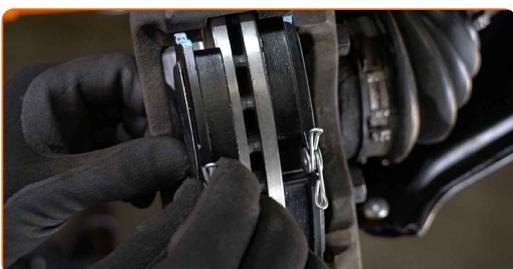
**18** Installieren Sie den Bremssattel und fixieren Sie diesen.
