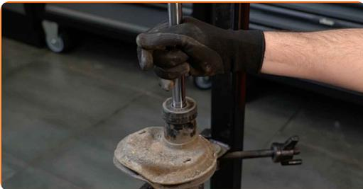
**47** Setzen Sie einen neuen Stoßdämpfer in den hydraulischen Federspanner ein.
