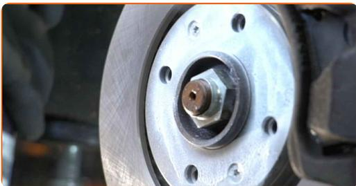
**83** Die Bremsscheibenoberfläche reinigen. Benutzen Sie einen Bremsenreiniger.
