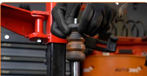
**49** Installieren Sie die Feder am Stoßdämpfer.
