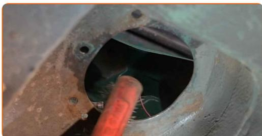
**56** Installieren Sie das Federbein am Radlauf.
