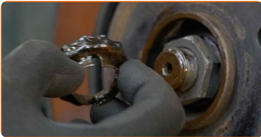
**19** Lösen Sie das Befestigungselement, welches die Antriebswelle mit der Radnabe verbindet. Verwenden Sie Stecknuss Nr. 36. Verwenden Sie ein Windeisen.
