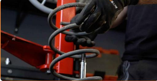
**46** Entnehmen Sie den alten Stoßdämpfer aus dem hydraulischen Spiralfederspanner.
