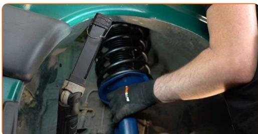
**57** Sichern Sie die oberen Befestigungen des Federbeines. Schrauben Sie diese nicht fest.
