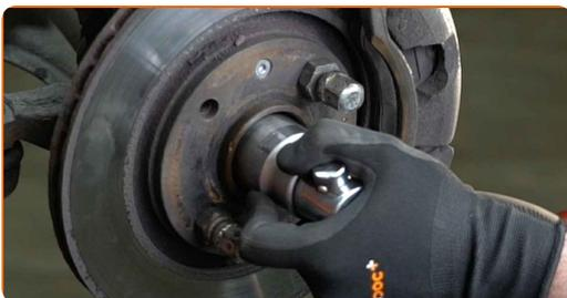
**20** Entfernen Sie die Befestigungsmutter.
