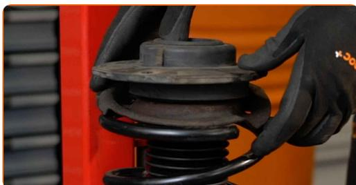
**52** Ziehen Sie die Federbeinkolbenstangenmutter an. Verwenden Sie eine 22 mm Schienenmutterstecknuss. Verwenden Sie Inbusschlüssel Nr. H6. Verwenden Sie einen Drehmomentschlüssel. Ziehen Sie ihn mit 50 Nm Drehmoment fest.
