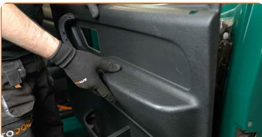
**10** Lösen Sie die Schalldämmung des Türblechs.
