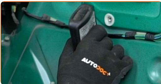
**21** Ziehen Sie die Befestigungselemente der Fensterheberbaugruppe fest. Verwenden Sie Stecknuss Nr. 10. Verwenden Sie einen Drehmomentschlüssel. Ziehen Sie ihn mit 12 Nm Drehmoment fest.
