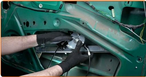
**20** Behandeln Sie das Gewinde der Befestigungen des Fensterhebers. Verwenden Sie eine Schraubensicherung.
