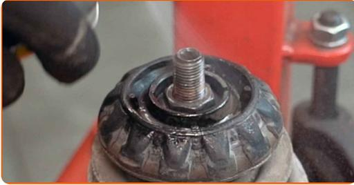
20 Entfernen Sie die Stangenmutter des Federkolben. Verwenden Sie Inbusschlüssel Nr. H6. Verwenden Sie Stecknuss Nr. 21. Verwenden Sie einen Ratschenschlüssel.
