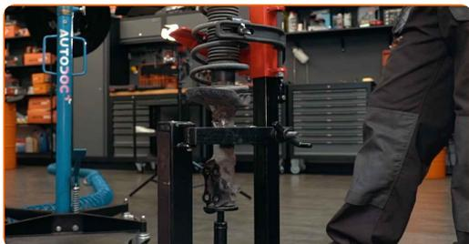
19 Behandeln Sie die Federbeinstange. Benutzen Sie eine Drahtbürste. Benutzen Sie WD-40-Spray.
