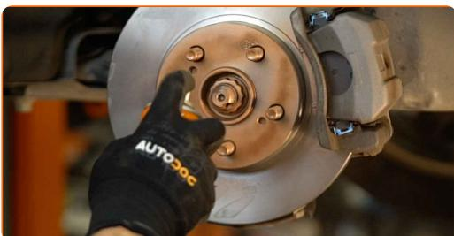
**31** Die Bremsscheibenoberfläche reinigen. Benutzen Sie einen Bremsenreiniger.
