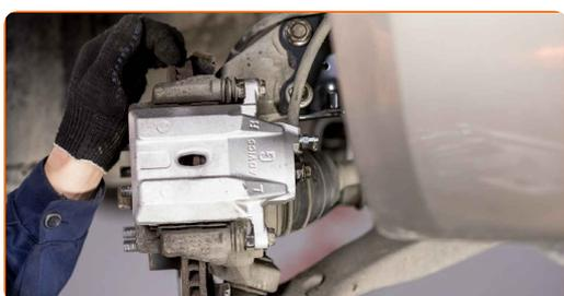
**27** Ziehen Sie die Entlüftungsschraube des Bremssattels an. Verwenden Sie Ring-Gabelschlüssel Nr. 9. Verwenden Sie einen Drehmomentschlüssel. Ziehen Sie ihn mit 8 Nm Drehmoment fest.
