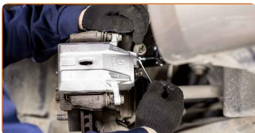
**26** Entlüften Sie das Bremssattelsystem. Ohne das Starten des Motors drücken Sie das Bremspedal mehrmals, bis Sie signifikanten Widerstand spüren.
