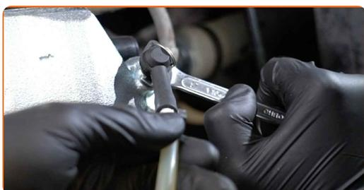
**28** Trennen Sie den Schlauch des Bremsentlüftungs-Kits.
