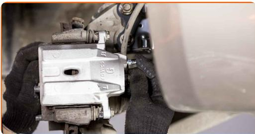
**29** Entfernen Sie den Schmutz von der Schraube zur Befestigung des Bremsschlauchs. Benutzen Sie einen Bremsenreiniger.
