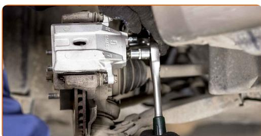
**22** Entfernen Sie die Klammer des Bremsschlauchs.
