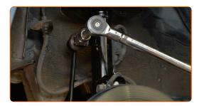
Ziehen Sie das Befestigungselement an, das die Druckstange mit dem Stabilisator verbindet. Verwenden Sie Stecknuss Nr. 19. Verwenden Sie einen Drehmomentschlüssel. Ziehen Sie ihn mit 74 Nm Drehmoment fest.
