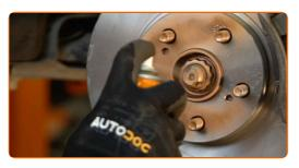
Die Bremsscheibenoberfläche reinigen. Benutzen Sie einen Bremsenreiniger.
