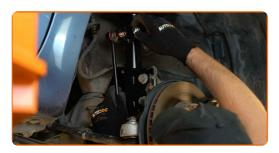
Ziehen Sie das Befestigungselement an, das die Druckstange mit dem Federbein verbindet. Verwenden Sie Stecknuss Nr. 19. Verwenden Sie einen Drehmomentschlüssel. Ziehen Sie ihn mit 74 Nm Drehmoment fest.
