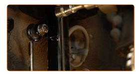
9 Entfernen Sie die Stabilisatorstange. Benutzen Sie ein Brecheisen.
