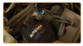
Bringen Sie die Zündspulen an den Zündkerzenbohrungen an. Stellen Sie sicher, dass Sie dabei das Klicken hören, welches entsteht, wenn sich diese in der korrekten Position befindet.
