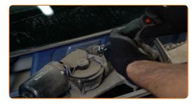
Schrauben Sie die Befestigungen des Sicherungskastens ein. Verwenden Sie Stecknuss Nr. 10. Verwenden Sie einen Ratschenschlüssel.
