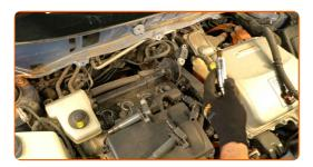
Tragen Sie eine dünne Schicht eines speziellen Hochtemperatur-Anti-Seize-Schmiermittels auf das Gewinde der neuen Zündkerzen auf.
