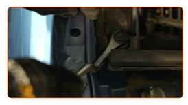
Behandeln Sie die Befestigungen des Wischergestänges. Benutzen Sie WD-40-Spray.
