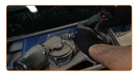
Schrauben Sie die Befestigungen des Sicherungskastens ab. Verwenden Sie Stecknuss Nr. 10. Verwenden Sie einen Ratschenschlüssel.
