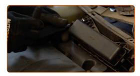
Entfernen Sie die Verkleidung, die mit dem Wischergestänge verbunden ist.
