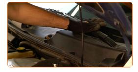
Ziehen Sie die Befestigungen der Wischerarme fest. Verwenden Sie Stecknuss Nr. 14. Verwenden Sie einen Drehmomentschlüssel. Ziehen Sie ihn mit 21 Nm Drehmoment fest.
