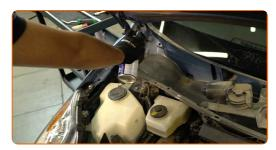
Lösen Sie den Steckverbinder des Scheibenwischermotors.
