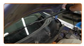
Entfernen Sie die Wischerarm-Abdeckungen. Verwenden Sie einen Lösehebel, um die Clips zu entfernen.
