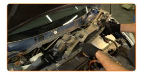
11 Reinigen Sie die Zündspulen.
