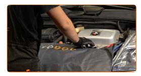
Lösen Sie die Befestigungen der Frontscheibenwischerarme. Verwenden Sie Stecknuss Nr. 14. Verwenden Sie einen Ratschenschlüssel.
