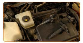
Schrauben Sie die neuen Zündkerzen an und ziehen Sie diese fest. Verwenden Sie die Zündkerzennuss # 16. Verwenden Sie einen Drehmomentschlüssel. Ziehen Sie ihn mit 18 Nm Drehmoment fest.
