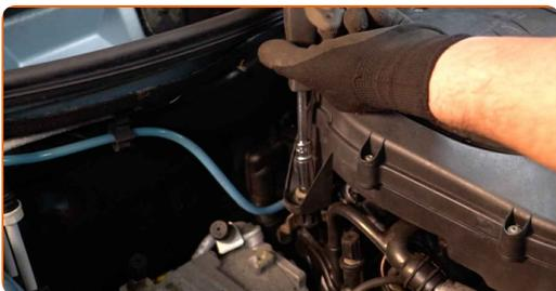
14 Bringen Sie die Haltefeder des Luftfiltergehäuses an.
