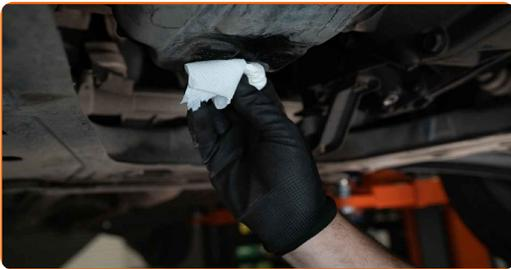
17 Schrauben Sie die neue Ablassschraube ein und ziehen Sie sie fest. Verwenden Sie einen Drehmomentschlüssel. Ziehen Sie ihn mit 34 Nm Drehmoment fest.
