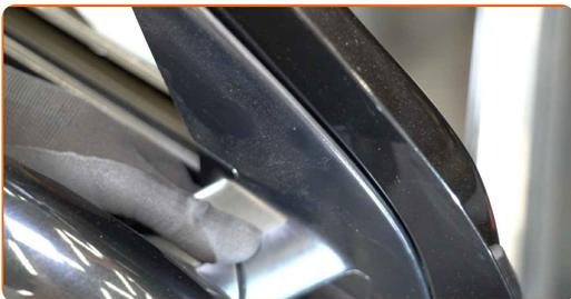
**12** Schrauben Sie die Befestigung des Außenspiegels ein. Verwenden Sie Stecknuss Nr. 10. Verwenden Sie einen Ratschenschlüssel.
