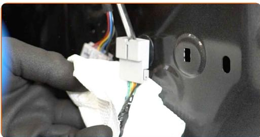
**14** Schließen Sie den Steckverbinder des Spiegelverstellers an der Tür wieder an.
