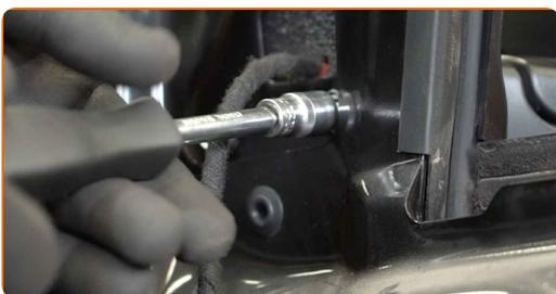
**13** Behandeln Sie den Steckverbinder des elektrischen Fensterheberschalters. Verwenden Sie dielektrisches Fett.
