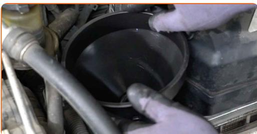
**23** Füllen Sie Öl durch den Einfüllstutzen in den Motor. Erforderliche Menge an Öl: 4,20 l.
