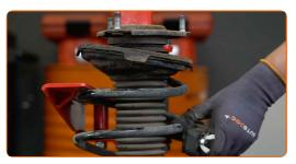
Entfernen Sie die Stangenmutter des Federkolben. Verwenden Sie Stecknuss Nr. 22. Verwenden Sie einen Ratschenschlüssel.
