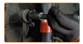
Ziehen Sie die unteren Befestigungen an, die das Federbein mit dem Achsschenkel verbinden. Verwenden Sie Ring-Gabelschlüssel Nr. 19. Verwenden Sie Stecknuss Nr. 19. Verwenden Sie einen Drehmomentschlüssel. Ziehen Sie ihn mit 143 Nm Drehmoment fest.
