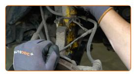
Schrauben Sie das obere Befestigungselement des Federbeins ab.
