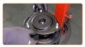
Ziehen Sie die Federbeinkolbenstangenmutter an. Verwenden Sie eine 19 mm Schienenmutterstecknuss. Verwenden Sie Inbusschlüssel Nr. H6. Verwenden Sie einen Drehmomentschlüssel. Ziehen Sie ihn mit 47 Nm Drehmoment fest.
