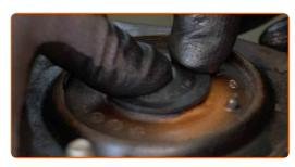
Entfernen Sie das zusammengebaute Federbein.
