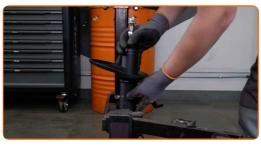
Installieren Sie die Feder am Stoßdämpfer.
