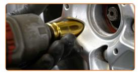
Senken Sie das Auto und ziehen Sie die Radschrauben über Kreuz an. Verwenden Sie eine Schlagnuss für Felgen # 19. Verwenden Sie einen Drehmomentschlüssel. Ziehen Sie ihn mit 103 Nm Drehmoment fest.
