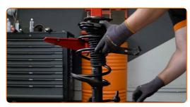
Reinigen Sie die Anbringungssitze des Federbeins. Benutzen Sie eine Drahtbürste. Benutzen Sie WD-40-Spray.
