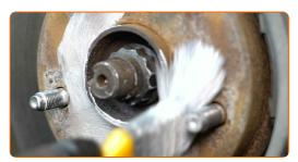
Die Bremsscheibenoberfläche reinigen. Benutzen Sie einen Bremsenreiniger.
