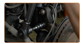
Entfernen Sie den Träger unter dem Achsschenkel.
