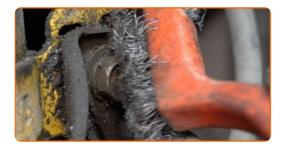
Schrauben Sie die Befestigung ab, die die Halterung des Bremsschlauchs mit dem Federbein verbindet. Verwenden Sie Stecknuss Nr. 12. Verwenden Sie einen Ratschenschlüssel.
