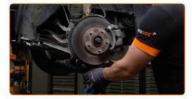
Entfernen Sie die Befestigungsschrauben.
