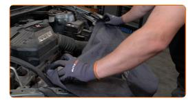
Entfernen Sie die Abdeckung vom Domlager. Benutzen Sie ein Brecheisen.
