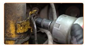
Entfernen Sie die Halterung des Bremsschlauchs.
