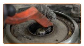
Lockern Sie die Mutter der Federbeinstange. Schrauben Sie sie nicht vollständig aus. Verwenden Sie Stecknuss Nr. 22. Verwenden Sie einen Ratschenschlüssel.
