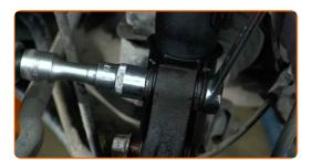
Entfernen Sie den Träger unter dem Achsschenkel.
