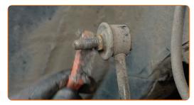
Behandeln Sie die Befestigung, die die Koppelstange mit dem Federbein verbindet. Benutzen Sie ein Kupferschmiermittel.
