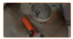
Reinigen Sie die Befestigung der Koppelstange. Benutzen Sie eine Drahtbürste.
