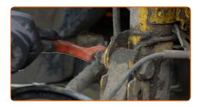
Schrauben Sie die Befestigungen ab, die das Federbein mit dem Achsschenkel verbinden. Verwenden Sie Ring-Gabelschlüssel Nr. 19. Verwenden Sie Stecknuss Nr. 19. Verwenden Sie einen Ratschenschlüssel.
