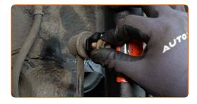
Schrauben Sie die Befestigung ein, die die Koppelstange mit dem Federbein verbindet. Verwenden Sie Stecknuss Nr. 14. Verwenden Sie einen Ratschenschlüssel.
