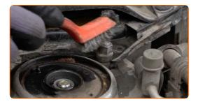
Lösen Sie die oberen Befestigungen des Federbeins. Verwenden Sie Stecknuss Nr. 14. Verwenden Sie einen Ratschenschlüssel.
