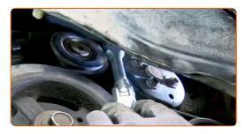
Drehen Sie die Kurbelwelle mehrmals, um zu überprüfen, ob der neue Keilrippenriemen sachgemäß funktioniert. Verwenden Sie Stecknuss Nr. 19. Verwenden Sie einen Ratschenschlüssel.
