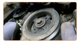
Ziehen Sie die Spannrolle des Keilrippenriemens beiseite. Verwenden Sie Stecknuss Nr. 19.
