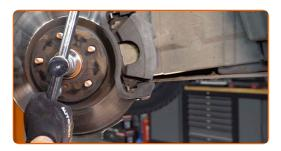
Die Bremsscheibenoberfläche reinigen. Benutzen Sie eine Drahtbürste.
