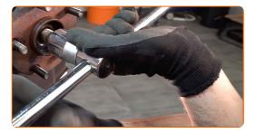
Behandeln Sie die Keilwellen des Antriebswellen-Gleichlaufgelenks. Benutzen Sie WD-40-Spray.
