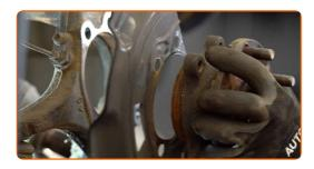
Reinigen Sie den Einbauort für die Nabenlagerung. Benutzen Sie eine Drahtbürste. Benutzen Sie WD-40-Spray.
