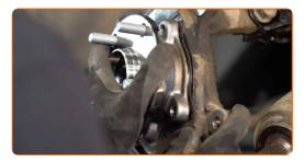
Ziehen Sie die Radnabenlager an. Verwenden Sie Stecknuss Nr. 17. Verwenden Sie einen Ratschenschlüssel.
