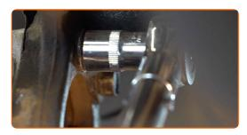
Behandeln Sie die Keilwellen des Antriebswellen-Gleichlaufgelenks. Benutzen Sie ein Kupferschmiermittel.
