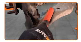
Lösen Sie das Befestigungselement, welches das Kugelgelenk am Federungsquerlenker befestigt. Verwenden Sie Stecknuss Nr. 17.
