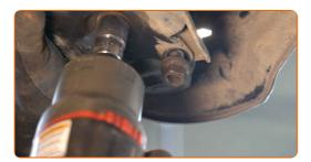
Ziehen Sie das Kugelgelenk an. Verwenden Sie Stecknuss Nr. 17. Verwenden Sie einen Drehmomentschlüssel. Ziehen Sie ihn mit 92 Nm Drehmoment fest.
