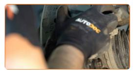
Befestigen Sie die Bremssattelhalterung. Verwenden Sie Stecknuss Nr. 18. Verwenden Sie einen Drehmomentschlüssel. Ziehen Sie ihn mit 98 Nm Drehmoment fest.
