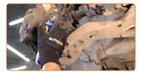
Lösen Sie die Befestigung der Sattelhalterung. Verwenden Sie Stecknuss Nr. 17. Verwenden Sie ein Windeisen.
