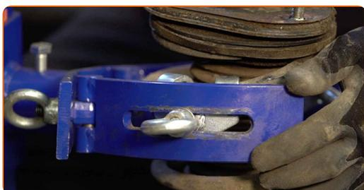
**22** Entfernen Sie die Kappe des Federbeinstützlagers.
