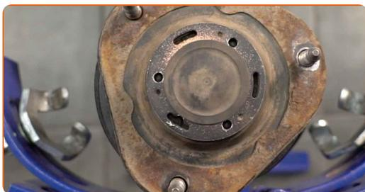
**37** Entfernen Sie das zusammengebaute Federbein.
