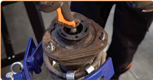
**24** Entfernen Sie die Stangenmutter des Federkolben. Verwenden Sie einen Universal-Riemenscheibenhalter. Verwenden Sie Stecknuss Nr. 19. Verwenden Sie einen Ratschenschlüssel.
