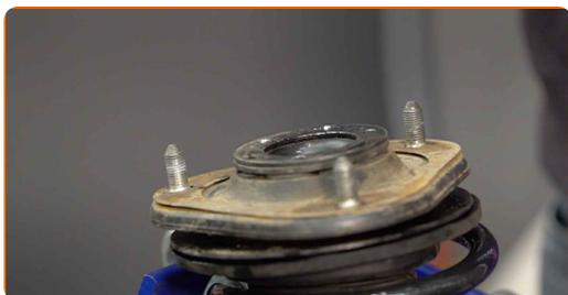
**33** Ziehen Sie die Federbeinkolbenstangenmutter an. Verwenden Sie einen Universal-Riemenscheibenhalter. Verwenden Sie Stecknuss Nr. 19. Verwenden Sie einen Drehmomentschlüssel. Ziehen Sie ihn mit 47 Nm Drehmoment fest.
