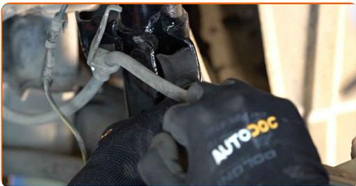
**44** Schrauben Sie das Befestigungselement ein, das das Federbein mit dem Achsschenkel verbindet. Verwenden Sie Stecknuss Nr. 22. Verwenden Sie Ring-Gabelschlüssel Nr. 22.
