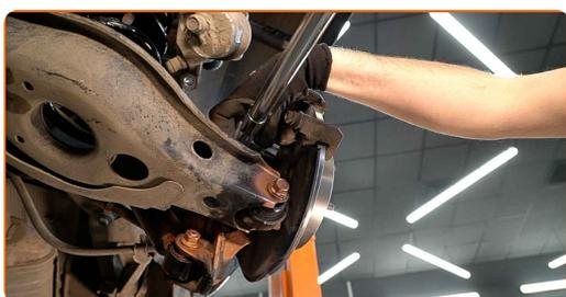
**23** Behandeln Sie den Bremssattel-Kolben. Benutzen Sie einen Bremsenreiniger.
