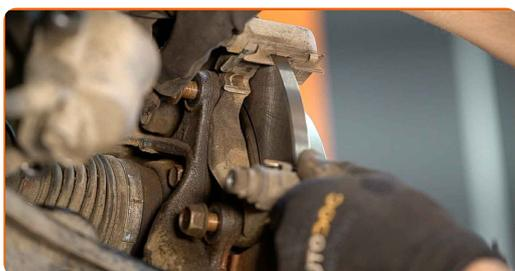
**22** Befestigen Sie die Bremssattelhalterung. Verwenden Sie Stecknuss Nr. 17. Verwenden Sie einen Drehmomentschlüssel. Ziehen Sie ihn mit 88 Nm Drehmoment fest.
