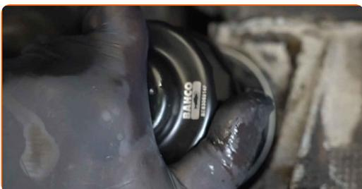
**16** Ziehen Sie die Befestigungselemente des Ölfilter fest. Denken Sie daran, das empfohlene Anzugsdrehmoment einzuhalten. Verwenden Sie Steckschlüssel 65-14F. Verwenden Sie einen Drehmomentschlüssel. Ziehen Sie ihn mit 24 Nm Drehmoment fest.
