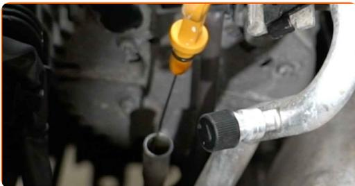
**4** Schrauben Sie die Öleinfüllschraube ab.
