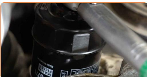
**17** Reinigen Sie den Ölfilter. Verwenden Sie Allzweckreinigungsspray.
