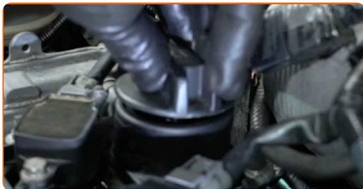
**27** Befestigen Sie den Deckel des Öleinfüllstutzens.
