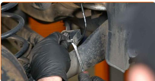
**11** Reinigen Sie die Stoßdämpferbefestigungen. Benutzen Sie eine Drahtbürste. Benutzen Sie WD-40-Spray.
