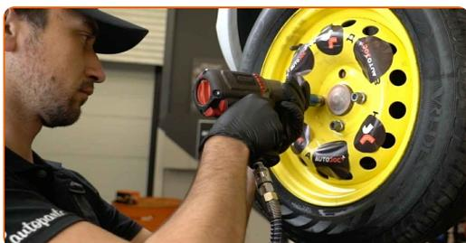
**28** Senken Sie das Auto und ziehen Sie die Radschrauben über Kreuz an. Verwenden Sie eine Schlagnuss für Felgen # 17. Verwenden Sie einen Drehmomentschlüssel. Ziehen Sie ihn mit 105 Nm Drehmoment fest.
