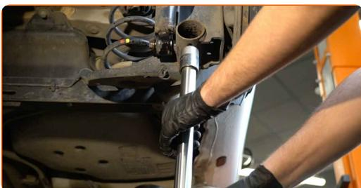
**13** Schrauben Sie den unteren Befestiger des Stoßdämpfers ab. Verwenden Sie Stecknuss Nr. 18. Verwenden Sie einen Ratschenschlüssel.
