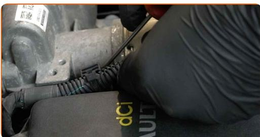
**8** Schrauben Sie das Verbindungsteil der Motorhaube ab. Verwenden Sie Stecknuss Nr. 10. Verwenden Sie einen Ratschenschlüssel.
