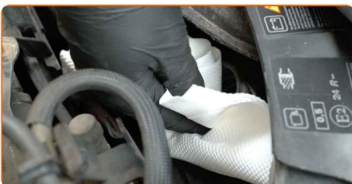
**7** Lösen Sie den Motorkabelbaum. Verwenden Sie einen flachen Schraubendreher.
