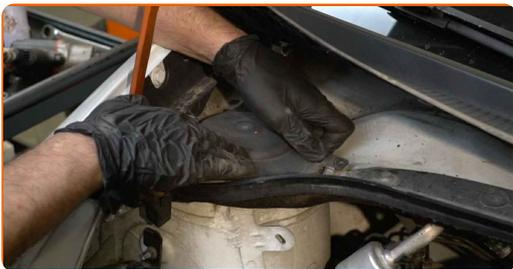
**63** Schrauben Sie die Befestigungen der Abdeckung des Federbeinstützlagers ein. Verwenden Sie Stecknuss Nr. 10. Verwenden Sie einen Ratschenschlüssel.
