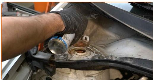
**62** Setzen Sie die Schutzkappe auf die Stoßdämpferstütze.
