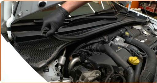
**4** Entfernen Sie die Clips des Windlaufs. Verwenden Sie einen Lösehebel, um die Clips zu entfernen.
