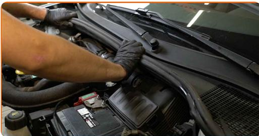
**67** Entfernen Sie die Kotflügel-Abdeckung.
