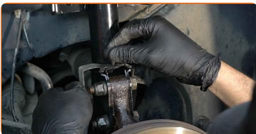
**48** Ziehen Sie die Befestigungsklammer des Bremsschlauchs am Federbein an. Verwenden Sie Stecknuss Nr. 10. Verwenden Sie einen Ratschenschlüssel.
