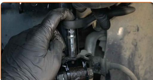
**49** Verbinden Sie das ABS mit der Sensorverdrahtung.
