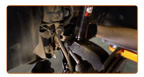
Befestigen Sie die Stabilisatorverbindung am Federbein. Verwenden Sie Inbusschlüssel Nr. H6. Verwenden Sie Ring-Gabelschlüssel Nr. 17. Verwenden Sie einen Drehmomentschlüssel. Ziehen Sie ihn mit 44 Nm Drehmoment fest.
