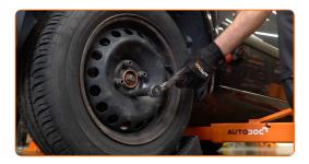
Ziehen Sie die obere Federbeinbefestigung an. Verwenden Sie Stecknuss Nr. 13. Verwenden Sie einen Drehmomentschlüssel. Ziehen Sie ihn mit 21 Nm Drehmoment fest.
