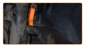
Schrauben Sie die Mutter ab und entfernen Sie die Stabilisatorstange aus dem Federbein. Verwenden Sie Inbusschlüssel Nr. H6. Verwenden Sie Ring-Gabelschlüssel Nr. 17.
