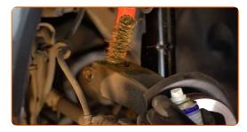
Befestigen Sie das Dämpferbein auf dem Achsschenkel.
