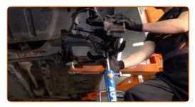
Setzen Sie eine neue Schraube für den Achsschenkel ein und ziehen Sie diese fest. Verwenden Sie Stecknuss Nr. 19. Verwenden Sie Ring-Gabelschlüssel Nr. 19. Verwenden Sie einen Drehmomentschlüssel. Ziehen Sie ihn mit 105 Nm Drehmoment fest.
