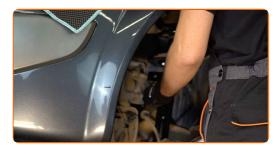
Sichern Sie die oberen Befestigungen des Federbeines (3 Stück). Schrauben Sie diese nicht fest.
