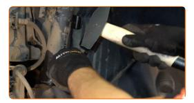
Schrauben Sie die untere Befestigung der Stoßdämpferstrebe ab. Verwenden Sie Stecknuss Nr. 13. Verwenden Sie einen Ratschenschlüssel.
