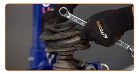
Setzen Sie das neue obere Federbeinlager ein.
