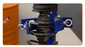
Entfernen Sie die Stangenmutter des Federkolben. Verwenden Sie Inbusschlüssel Nr. H6. Verwenden Sie Ring-Gabelschlüssel Nr. 18. Verwenden Sie einen Ratschenschlüssel.
