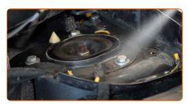
Lösen Sie die obere Befestigung des Domlagers. Verwenden Sie Stecknuss Nr. 13. Verwenden Sie einen Ratschenschlüssel.
