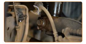
Untere Befestigung der Stoßdämpferfedern abschrauben. Verwenden Sie Stecknuss Nr. 19. Verwenden Sie ein Windeisen.
