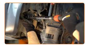
Entfernen Sie den Träger unter dem Achsschenkel.
