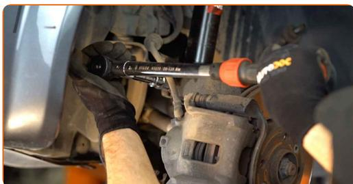
**42** Entfernen Sie den Träger unter dem Achsschenkel.
