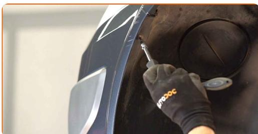
**51** Bauen Sie die untere Schallisolierung ein.
