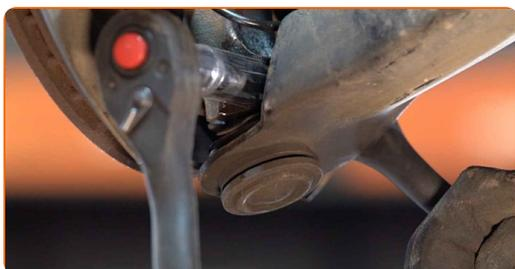
**21** Entfernen Sie die Befestigungsschraube. Benutzen Sie einen Hammer. Verwenden Sie einen Splintentreiber.
