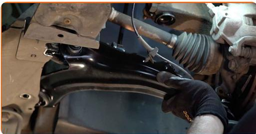
**30** Verbinden Sie das Kugelgelenk mit dem Achsschenkel.
