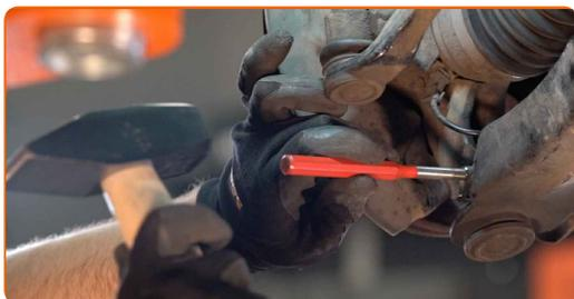
**22** Schrauben Sie die vordere Armbefestigung ab. Verwenden Sie Stecknuss Nr. E16. Verwenden Sie Ring-Gabelschlüssel Nr. 18. Verwenden Sie einen Ratschenschlüssel.
