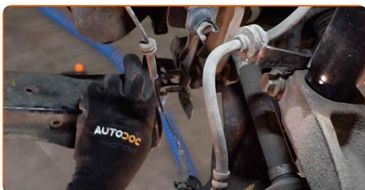
**24** Schrauben Sie die hintere Armbefestigung ab. Verwenden Sie Stecknuss Nr. 18. Verwenden Sie Ring-Gabelschlüssel Nr. 18. Verwenden Sie einen Ratschenschlüssel.
