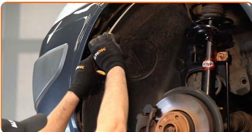
**11** Reinigen Sie die Befestigungselemente des Bewehrungsstabs des Stoßfängers und dessen Halterung. Benutzen Sie eine Drahtbürste. Benutzen Sie WD-40-Spray.
