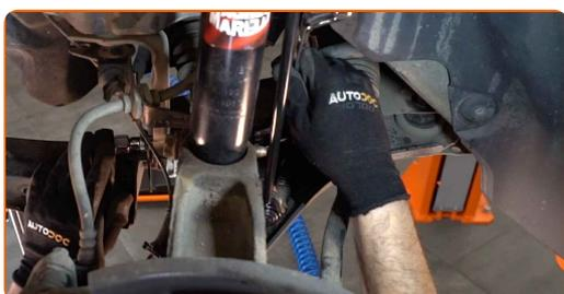
**23** Entfernen Sie die Befestigungsschraube. Benutzen Sie ein Brecheisen.
