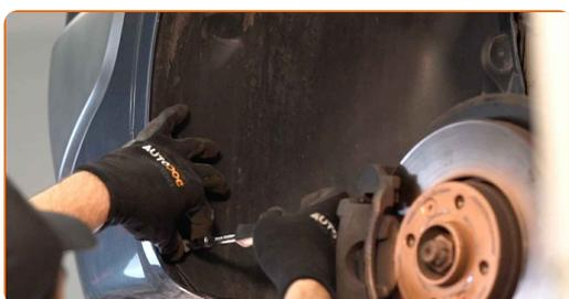
**10** Entfernen Sie die Radkastenabdeckung.
