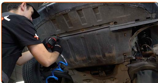
**9** Schrauben Sie die Befestigungselemente der Radkastenabdeckung heraus und entfernen Sie sie. Verwenden Sie den Torx T20. Verwenden Sie einen Lösehebel, um die Clips zu entfernen.
