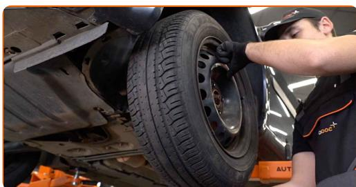
**8** Bauen Sie den unteren Schallschutz aus. Verwenden Sie Stecknuss Nr. 12.
