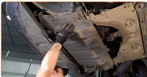
**52** Schrauben Sie die Verbindungselemente der Schalleindrucksdämmung ein. Verwenden Sie Stecknuss Nr. 12.
