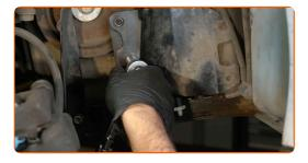
Entfernen Sie den Befestigungswinkel des Kraftstofffilters.
