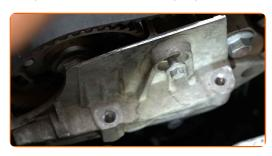
Ziehen Sie die Befestigungsschrauben des Motorlagers an. Verwenden Sie Stecknuss Nr. 10. Verwenden Sie einen Drehmomentschlüssel. Ziehen Sie ihn mit 40 Nm Drehmoment fest.
