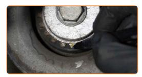
Bauen Sie die Nockenwellenradarretierung anhand der Werksmarkierungen ein. Verwenden Sie einen Motoreinstellwerkzeugssatz.
