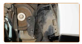
Schrauben Sie die Befestigungsbolzen der Treibstofffilterhalterung an. Verwenden Sie Stecknuss Nr. 13. Verwenden Sie einen Ratschenschlüssel.
