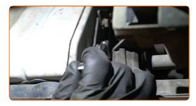
101 Installieren Sie den Befestigungswinkel des Kraftstoffilters.
