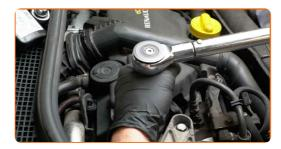
Entfernen Sie den Träger unter dem Motor.
