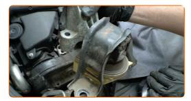
Entfernen Sie die obere Zahnriemenabdeckung.
