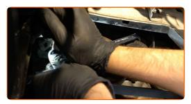
Schrauben Sie die Befestigungen des Hilfsrahmens ein. Verwenden Sie Stecknuss Nr. 18. Verwenden Sie einen Ratschenschlüssel.
