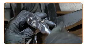
Schrauben Sie die Hilfsrahmenbefestigung ab. Verwenden Sie Stecknuss Nr. 18. Verwenden Sie einen Ratschenschlüssel.
