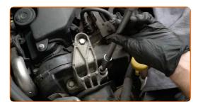
Entfernen Sie den oberen Teil des Motorlagers.
