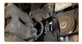
Schrauben Sie die Befestigungen der Verstärkungsstrebe des Hilfsrahmens fest. Verwenden Sie Stecknuss Nr. 13. Verwenden Sie einen Drehmomentschlüssel. Ziehen Sie ihn mit 35 Nm Drehmoment fest.
