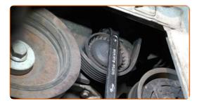
17 Entfernen Sie den Keilrippenriemen.
