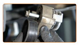
Entfernen Sie die mittlere Zahnriemenabdeckung.
