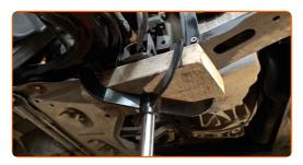
Reinigen Sie die Befestigungen des Hilfsrahmens. Benutzen Sie eine Drahtbürste. Benutzen Sie WD-40-Spray.
