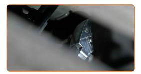
Ziehen Sie die Spannrolle des Keilrippenriemens beiseite. Verwenden Sie Ring-Gabelschlüssel Nr. 16.
