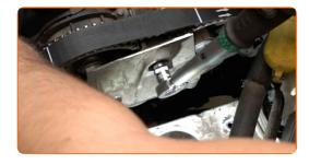
Bauen Sie die obere Zahnriemenabdeckung ein. Stellen Sie sicher, dass Sie dabei das Klicken hören, welches entsteht, wenn sich diese in der korrekten Position befindet.
