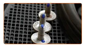
Ziehen Sie das obere Befestigungselement des Motorlagers an. Verwenden Sie Stecknuss Nr. 16. Verwenden Sie einen Drehmomentschlüssel. Ziehen Sie ihn mit 76 Nm Drehmoment fest.
