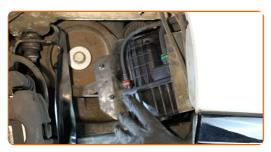
Schrauben Sie die Befestigungsbolzen der Treibstofffilterhalterung an. Verwenden Sie Ring-Gabelschlüssel Nr. 10.
