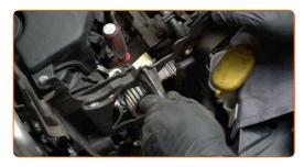
Lösen Sie die Klemme der unteren Kühlmittelleitung. Verwenden Sie die Lange Rundzange.
