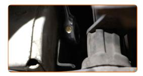
Entfernen Sie den Befestigungswinkel des Kraftstofffilters.
