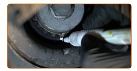
Lockeren Sie die Befestigung der Spannrolle des Zahnriemens. Verwenden Sie Ring-Gabelschlüssel Nr. 13. Verwenden Sie Inbusschlüssel Nr. H6.
