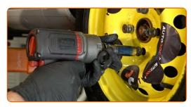
Senken Sie das Auto und ziehen Sie die Radschrauben über Kreuz an. Verwenden Sie eine Schlagnuss für Felgen # 17. Verwenden Sie einen Drehmomentschlüssel. Ziehen Sie ihn mit 105 Nm Drehmoment fest.
