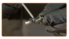
Bauen Sie die Wasserpumpendichtung ein.
