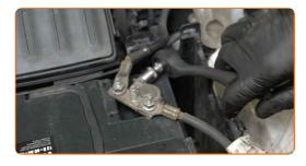
Entfernen Sie die Batterieklemmen.
