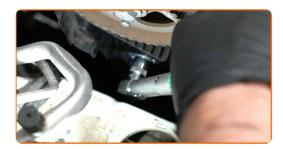
Behandeln Sie die Befestigungen des Motorlagers. Verwenden Sie ein Dichtmittel.
