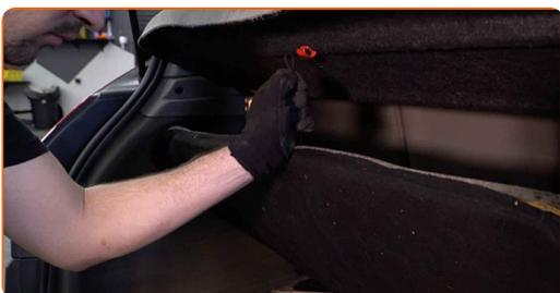
**3** Schrauben Sie das obere Befestigungselement des Stoßdämpfers ab. Verwenden Sie Stecknuss Nr. 16. Verwenden Sie einen Ratschenschlüssel.
