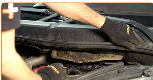
21 Entfernen Sie die Kotflügel-Abdeckung.
