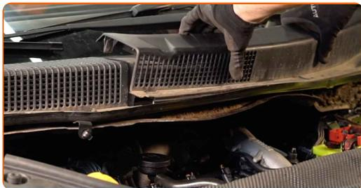
**6** Schrauben Sie die Befestigungsschrauben der Schutzabdeckung ab. Verwenden Sie Stecknuss Nr. 10. Verwenden Sie einen Ratschenschlüssel.
