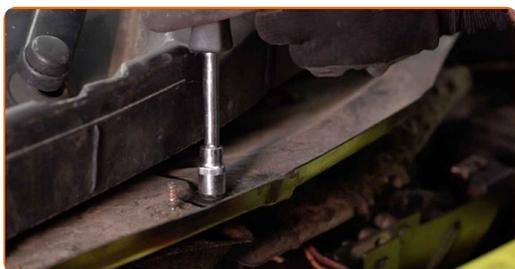
**7** Entfernen Sie die Schutzabdeckung.
