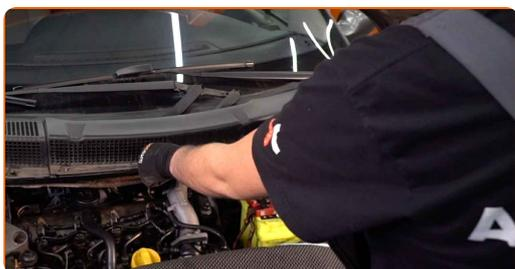
**19** Schrauben Sie das Befestigungselement der Windlaufabdeckung ein, die sich an der linken Seite befindet. Verwenden Sie Stecknuss Nr. 10. Verwenden Sie einen Ratschenschlüssel.
