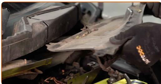
**8** Schrauben Sie die Filtergehäuse-Befestigungsbolzen ab. Verwenden Sie einen Kreuzschlitzschraubendreher.
