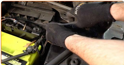
**9** Heben Sie ein wenig die obere Schutzabdeckung an. Entfernen Sie das Luftfiltergehäuse.
