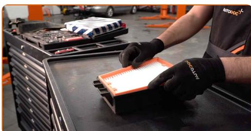
**Austausch: Luftfilter – RENAULT Megane III Schrägheck (BZ0/1\_). Tipp von AUTODOC:**
