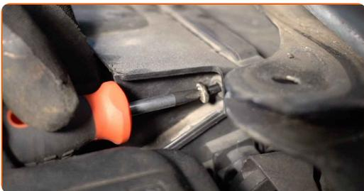
**16** Installieren Sie die Schutzabdeckung.
