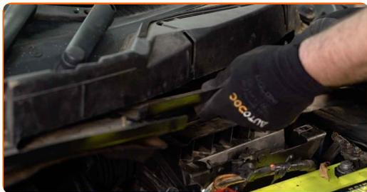
**17** Ziehen Sie die Befestigungsschrauben der Schutzabdeckung fest. Verwenden Sie Stecknuss Nr. 10. Verwenden Sie einen Ratschenschlüssel.
