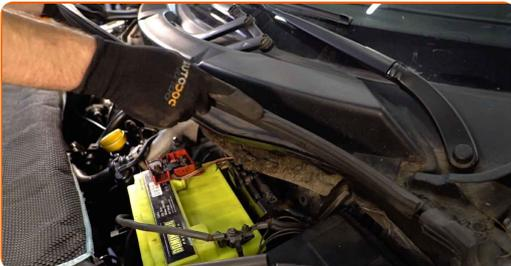
**5** Entfernen Sie die Windlaufabdeckung, die sich an der linken Seite befindet.
