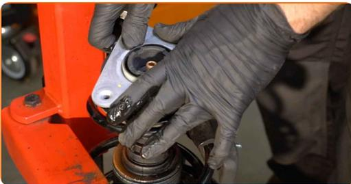
**35** Ziehen Sie die Federbeinkolbenstangenmutter an. Verwenden Sie Stecknuss Nr. 18. Verwenden Sie Inbusschlüssel Nr. H6. Verwenden Sie einen Drehmomentschlüssel. Ziehen Sie ihn mit 62 Nm Drehmoment fest.
