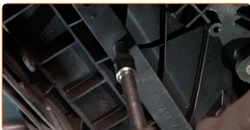
**3** Entfernen Sie den Gehäusedeckel des Innenraumfilters.
